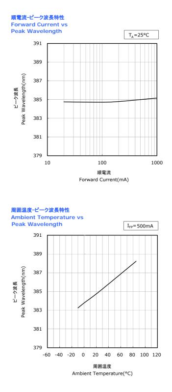
\* 本特性はピーク波長ランクU385に対応しています。 The graphs above show the characteristics for U385 LEDs of this product.
