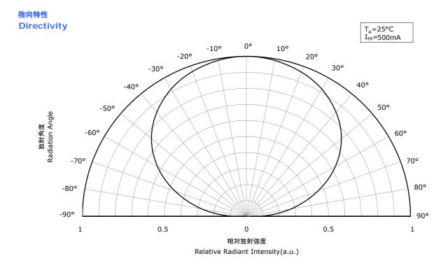
\* 本特性はピーク波長ランクU385に対応しています。 The graphs above show the characteristics for U385 LEDs of this product.
