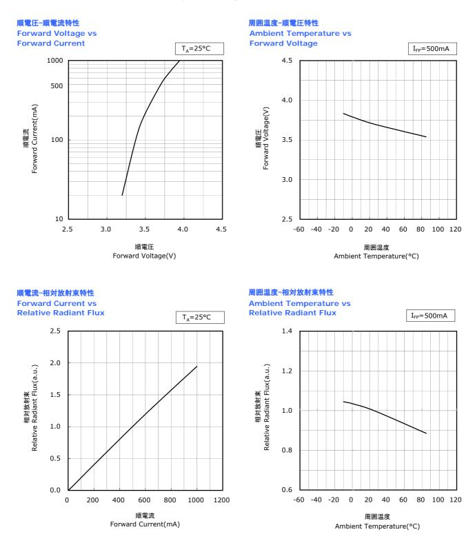
\* 本特性はピーク波長ランクU385に対応しています。 The graphs above show the characteristics for U385 LEDs of this product.
