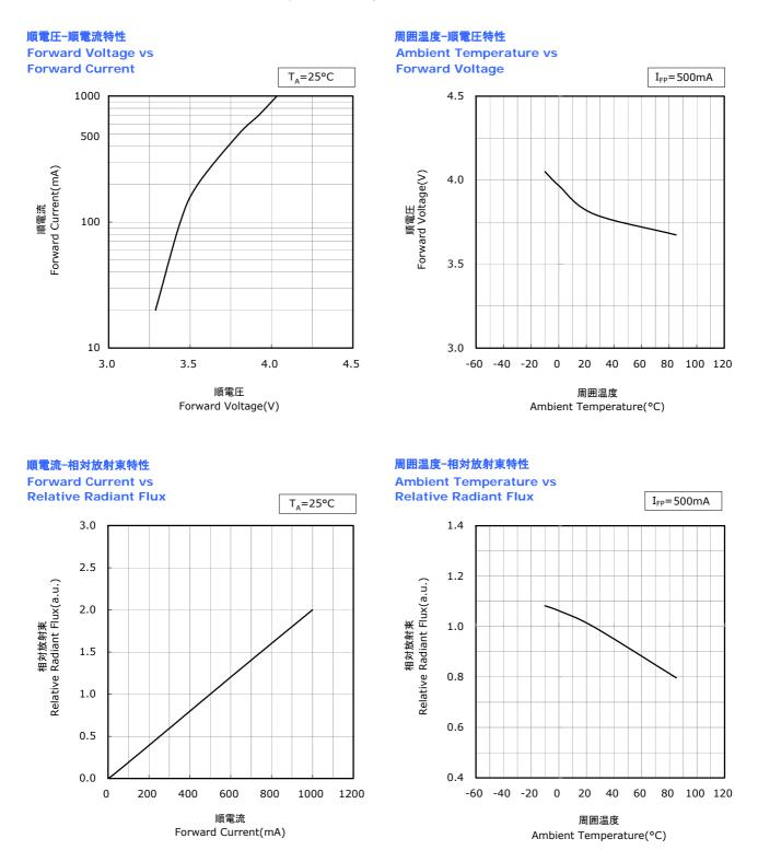
\* 本特性はピーク波長ランクU365に対応しています。 The graphs above show the characteristics for U365 LEDs of this product.
