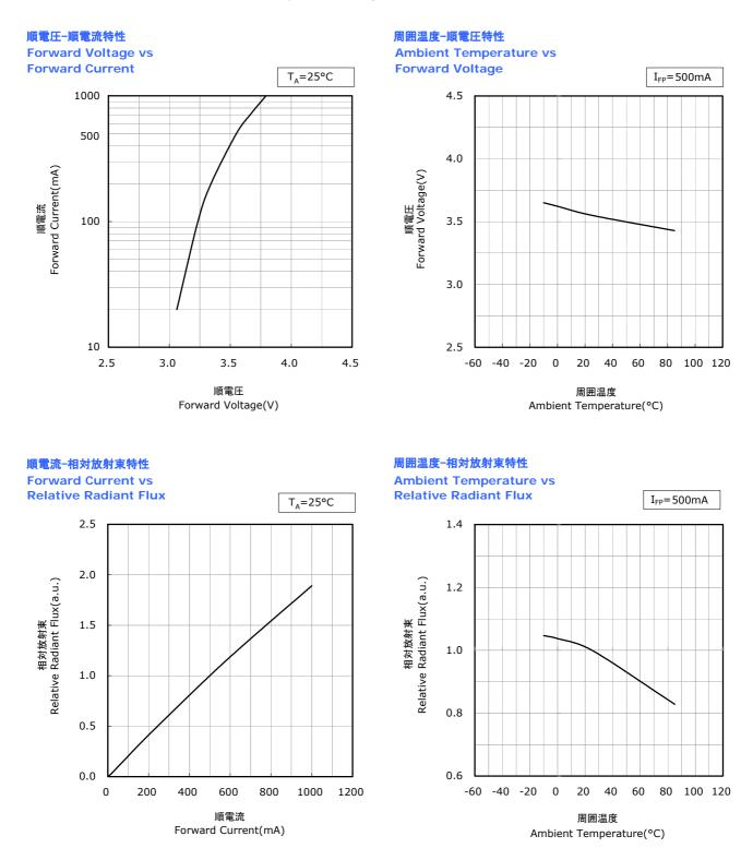
\* 本特性はピーク波長ランクU405に対応しています。 The graphs above show the characteristics for U405 LEDs of this product.
